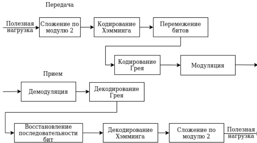
Рис. 1. Упрощенная схема приема и передача сигнала в модуле gr-lora_sdr
